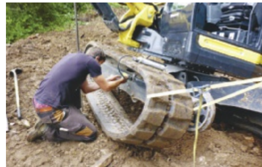
Niklaus Tanner montiert die Raupe zurück an den Bagger.
