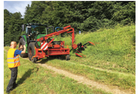
Das auf Böschungsunterhalt spezialisierte Unternehmen AmTech GmbH präsentiert den Mitarbeitern des AVT seine Lösung für die ökologisch schonende Mahd mit Doppelmesserbalken.
